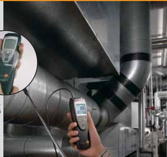
testo 416, par ex. pour des mesures de débit d'air en extraction
