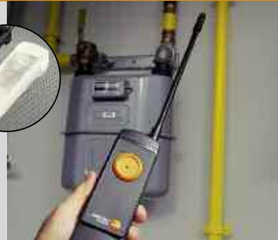
Contrôle d'étanchéité sur des conduites de gaz d'installations domestiques
