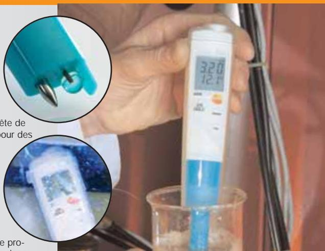
Contrôle rapide du pH, par exemple sur des rejets d'eau
