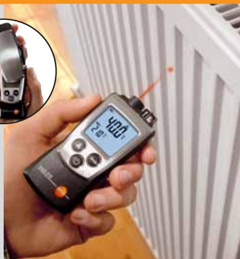
Contrôle de température sur un radiateur
