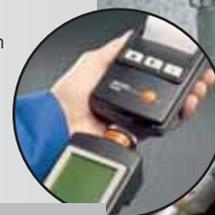
Réglage de pression gaz sur une chaudière
