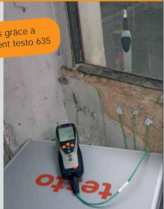
Détermination du coefficient U d'une paroi à rénover avec une sonde facteur U et une sonde radio de température. Ecran très lisible grâce à un affichage rétro-éclairé.
