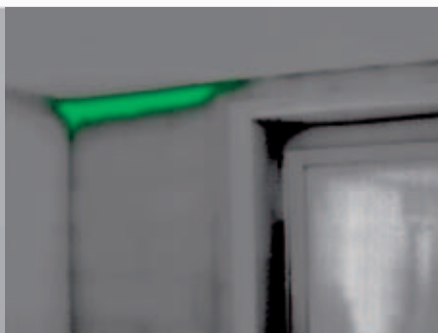
Représentation de l'humidité pour détecter les zones à risque de développement moisissures
