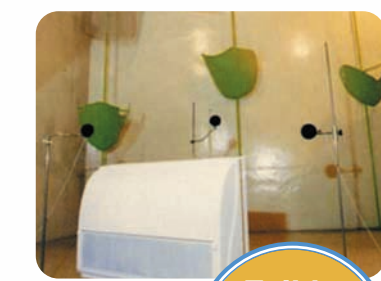
Essais acoustiques en chambre réverbérante
