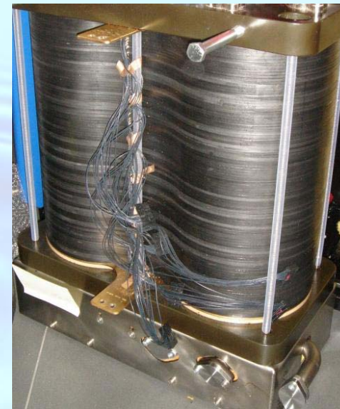
PEMFC HT Système de 2.5 kW à 5.0 kW composé de deux modules
