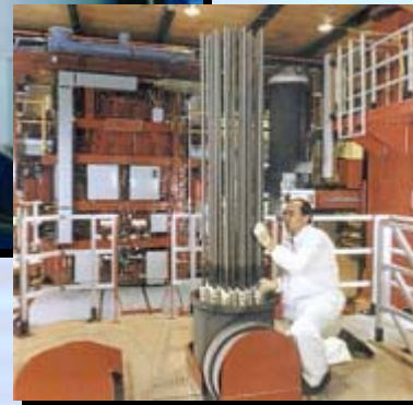
Siemens Westinghouse : unité de 220 kW couplée à une turbine à gaz
